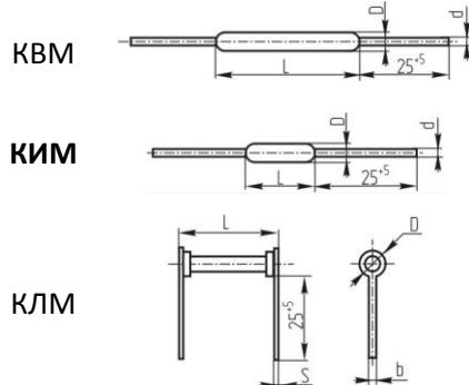
Постоянные непроволочные резисторы КВМ, КИМ, КЛМ предназначены для работы в цепях постоянного и переменного тока.
